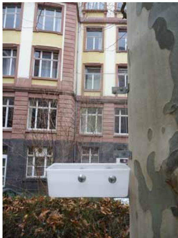
Abb. 1: Stammfensterfalle (hier an einer Platane vor dem Senckenberg-Institut, Foto: W. H. O. Dorow)
